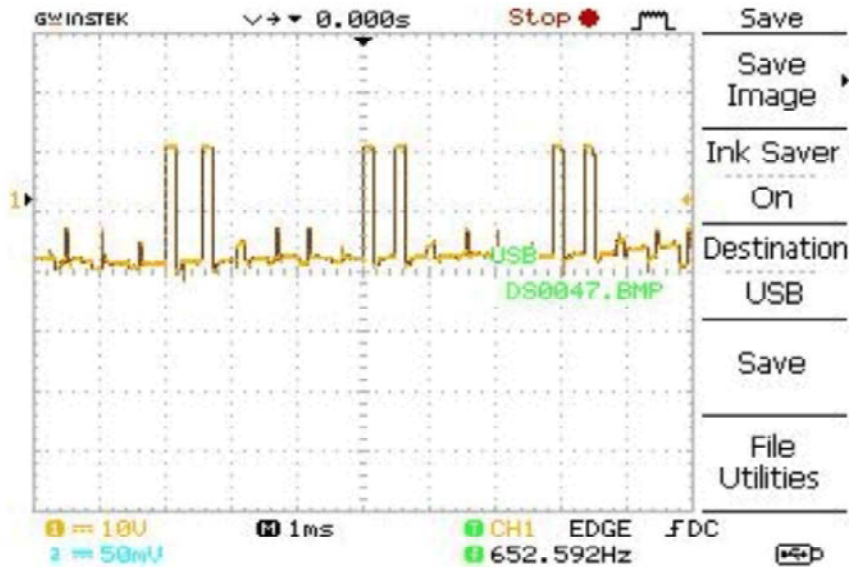
Fig. 16: Gate Pulse to FSTPI Switch S3
