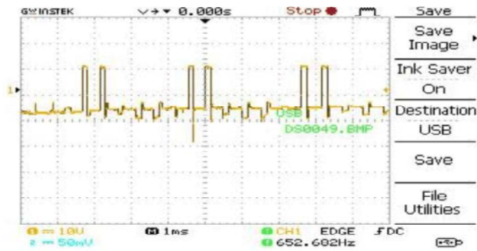
Fig. 19: Gate Pulse to FSTPI Switch S6
