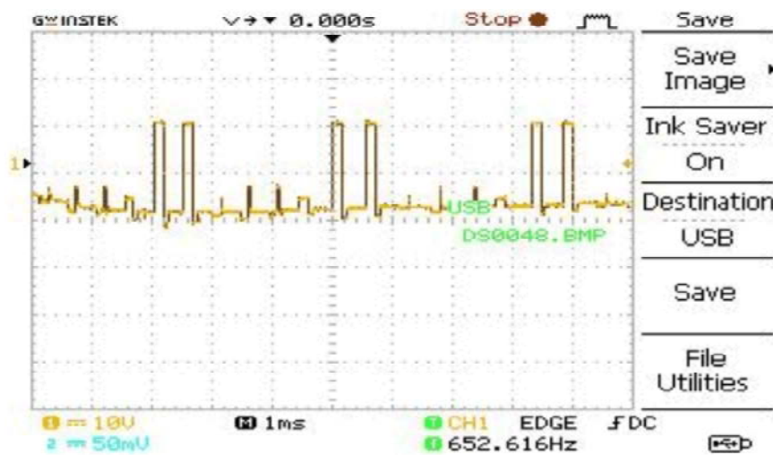
Fig. 18: Gate Pulse to FSTPI Switch S5
